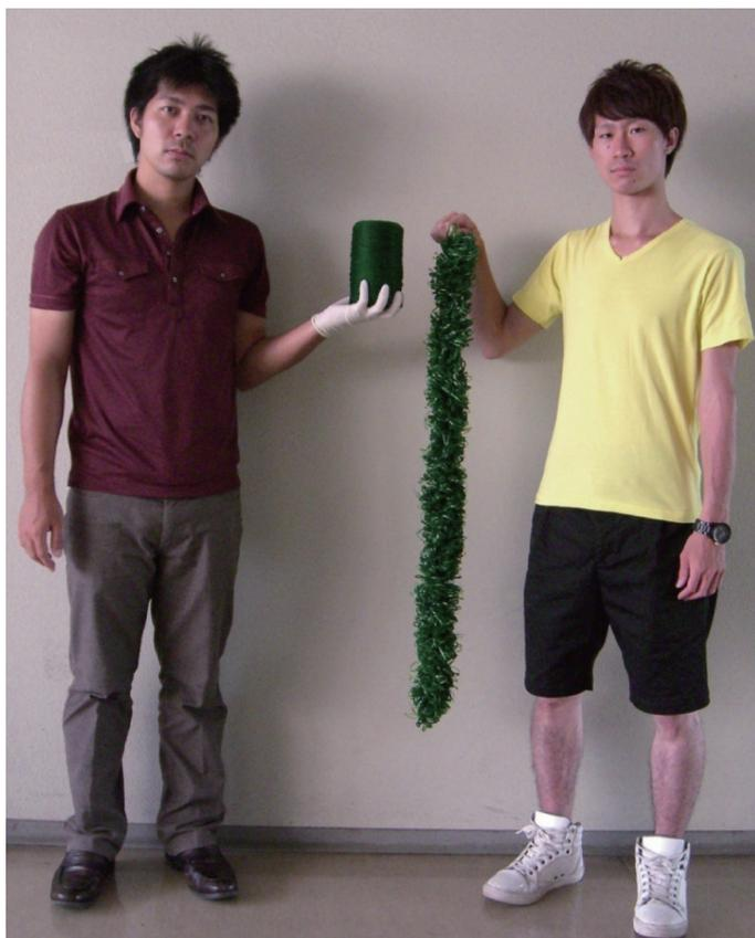
Fig. 1 フェロシアン化コバルト担持繊維の“組みひも”状の集合体
