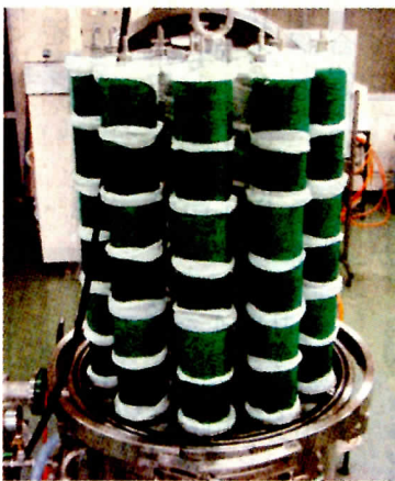
ナイロン繊維を反応させて吸着材に仕上げる
